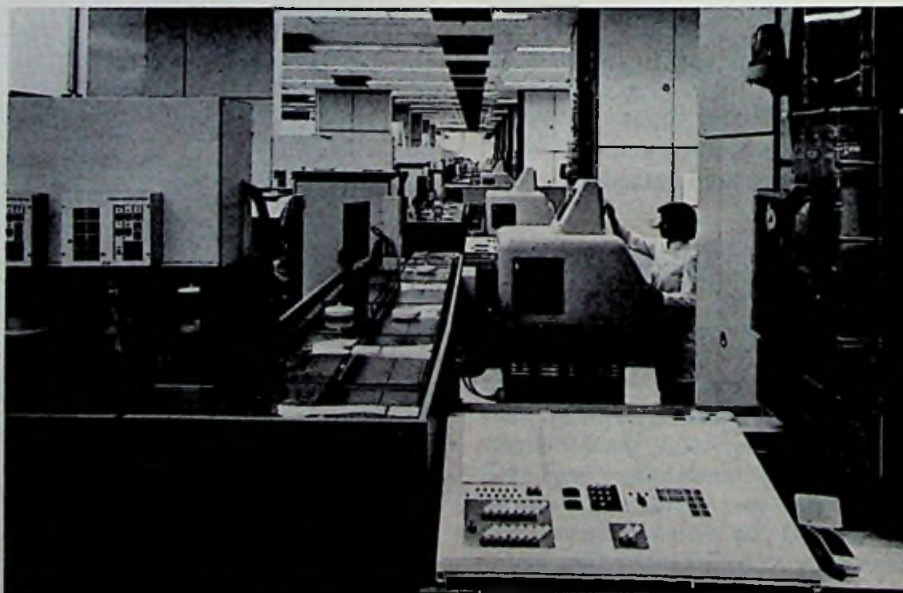
Bild 1. In dieser Fertigungsstraße sind die automatisch arbeitenden Fertigungseinrichtungen durch ein System für den berührungslosen Transport der Wafer miteinander verbunden
