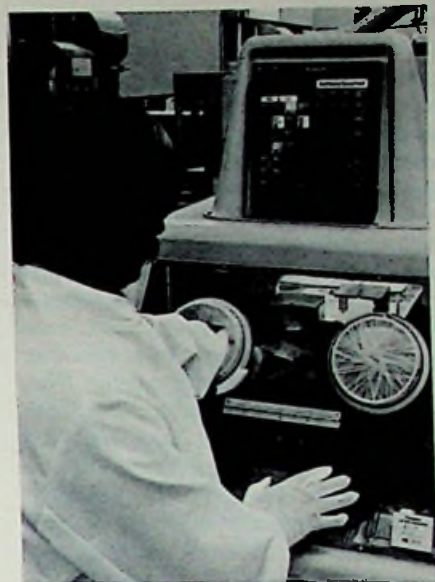
Bild 2. Lade- und Entnahmestation, in der die Wafer in den automatischen Fertigungsprozeß eingegeben werden und wohin sie nach der Bearbeitung wieder zurückkehren
